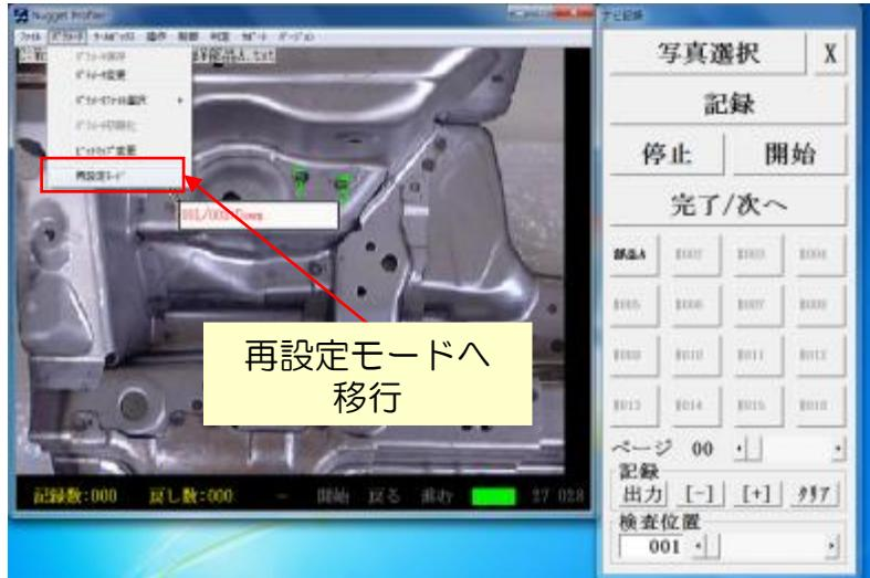
一度作成したパラメータファイルの変更・修正を行うとき、再設定モードを使用します。
